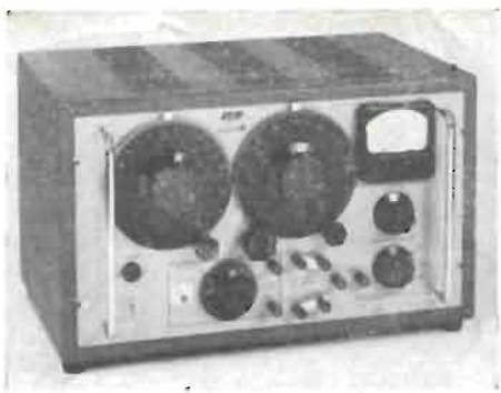
Il LABORATOIRE ELECTRO-ACUSTIQUE presenta un generatore a battimenti di grande stabilità e bassa distorsione. È il modello GMB1 (tara in dB) destinato alla gamma da 1 a 600 KHz, raffigurato qui sopra. Nella foto inferiore è invece riprodotto un nuovo ponte universale (mod. IPT1) per misure di resistenze, induttanze, capacità entro gamme assai estese.
