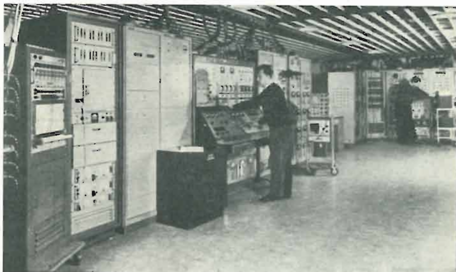
Complesso di tracking nella sala operazioni dell'installazione Minitrack della stazione britannica di ricerca radio a Winkfield, presso Londra. La stazione riceve dati telemetrici dal satellite e li ritrasmette per telescrivente negli Stati Uniti.
