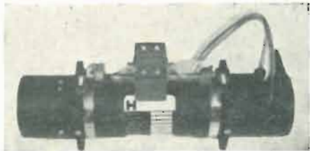
Fig. 6 - Esempio di tubo di potenza ad onde progressive, che adotta elementi a banda larga.
