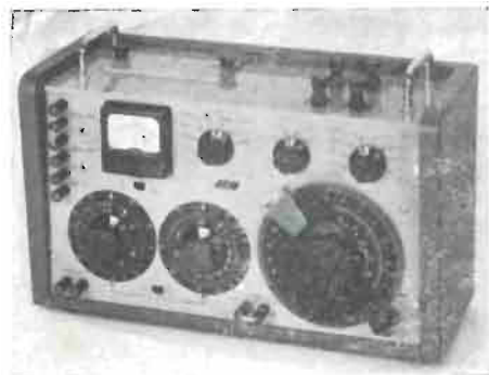
Il LABORATOIRE ELECTRO-ACUSTIQUE presenta un generatore a battimenti di grande stabilità e bassa distorsione. È il modello GMB1 (tara in dB) destinato alla gamma da 1 a 600 KHz, raffigurato qui sopra. Nella foto inferiore è invece riprodotto un nuovo ponte universale (mod. IPT1) per misure di resistenze, induttanze, capacità entro gamme assai estese.
