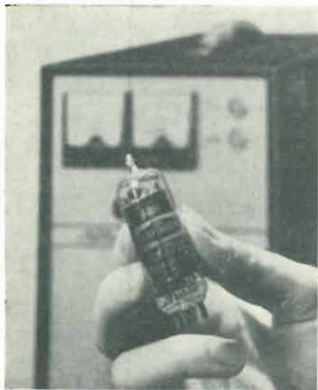
La RAYTHEON Co. costruisce un tubo a fascio, il CK6216, a bassa caduta e alta resistenza anodica d'impiego molteplice. Amplificatore in classe A il CK6216 può dare 3,8 W al 10% di distorsione con una tensione anodica di 200 V.
